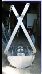
Benna Van Veen da 25 l Superficie di campionamento 0,18 m 2
